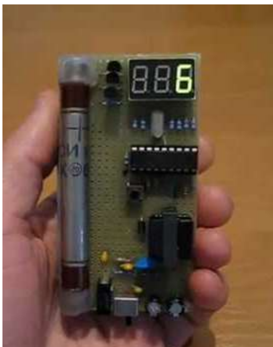
Рисунок 4 — Дозиметр на принципе работы счетчика Гейгера-Мюллера
